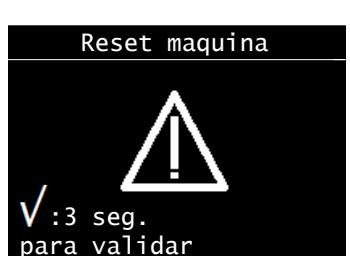
Cuando «Reinicio máquina» está seleccionado en el menú Configuración, presionar una vez en menú/validar hace entrar el equipo en el sub-menú de reinicio de máquina.
