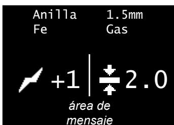
En Modo Sinérgico, el tiempo y corriente de las diferentes fases de la soldadura están determinados automáticamente por el producto.
