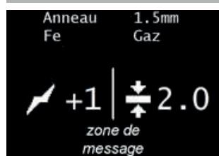
En Mode Synergique, les temps et courants des différentes phases de la soudure sont déterminés automatiquement par le produit.
