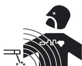
La corriente eléctrica causa campos electromagnéticos (EMF) localizados al pasar por cualquier conductor. La corriente de soldadura produce un campo electromagnético alrededor del circuito de soldadura y del material de soldadura.
