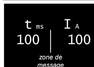
En Mode Manuel, les temps, courants et coefficients des différentes phases de la soudure sont à renseigner par l'utilisateur.
